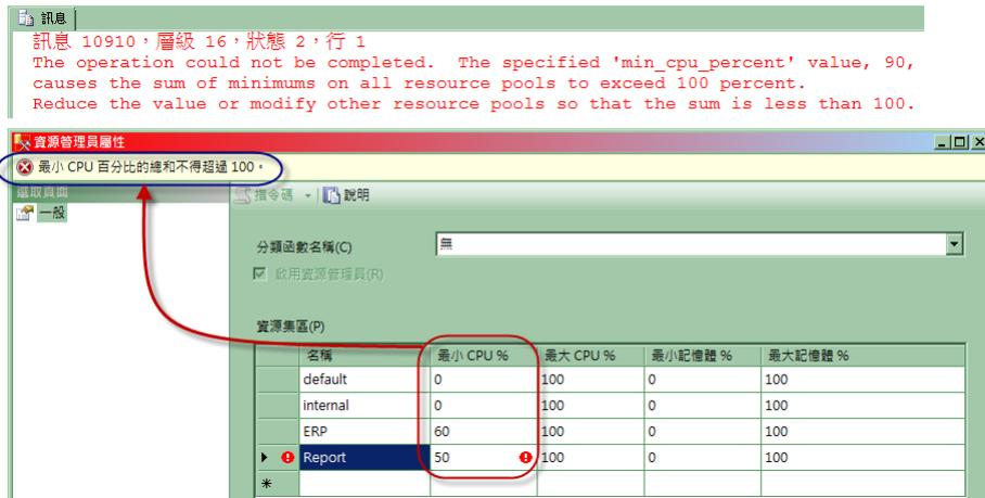
圖 5：各個「資源集區」的 CPU 之 MIN 值，總和超過 100%的限制
